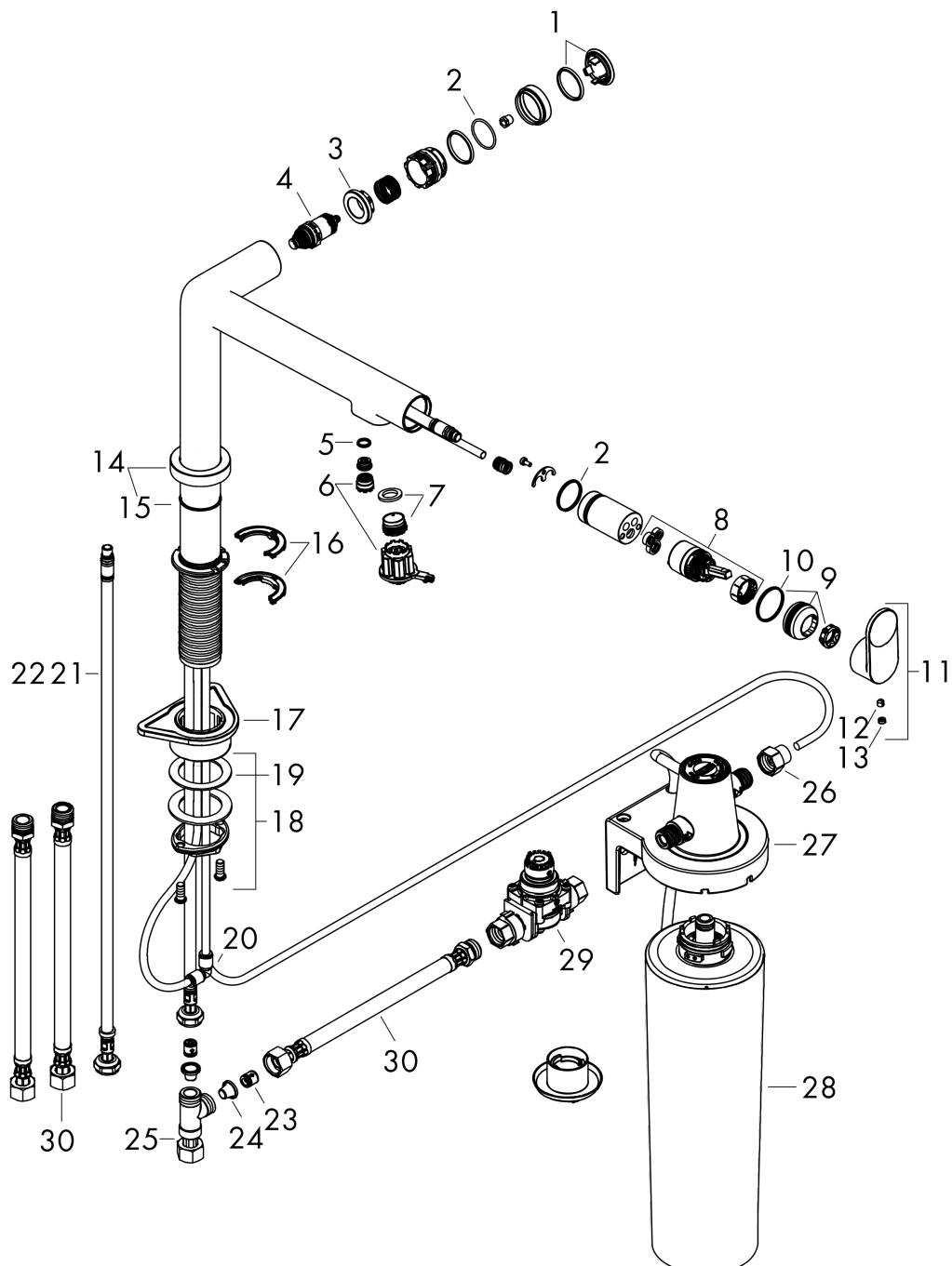
**Aqittura M91****FilterSystem 240, 1jet, Starter Set**Oberfläche: **Edelstahl Finish** Artikelnummer: **76802800**
